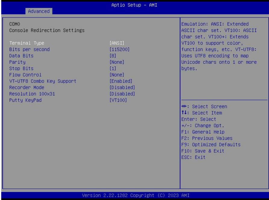
本界面只有在 Console Redirection 选 Enabled 下才能打开，主要配置 COM 的波特率，奇偶校验位，数据位等等串口重定向细部操作。
